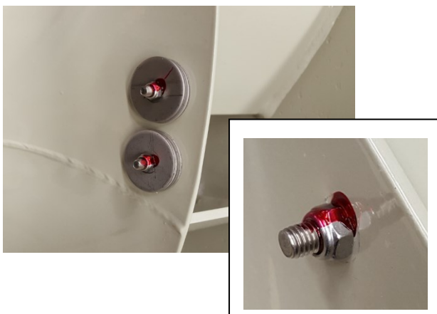
Figure : Schéma de principe : Blocage des poids d'équilibrage à l'aide d'un vernis de scellement de couleur (Loctite SF 7400 ou vernis frein filet SF 7240)
